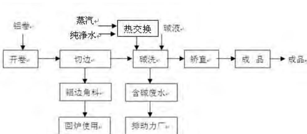
图 3-7 厚拉弯矫直生产工艺流程图
